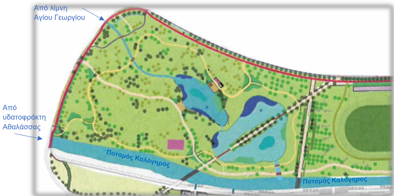
Σχέδιο 8.1: Η υφιστάμενη (αριστερά) και προτεινόμενη λίμνη (δεξιά) εντός της περιοχής του masterplan και η υδραυλική τους σύνδεση με τον ποταμό Καλόγηρο.
